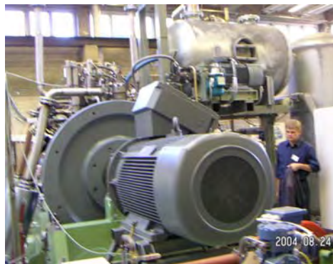
図 9 見学会: 船用巨大単筒試験機関 (ヘルシンキ工大)
